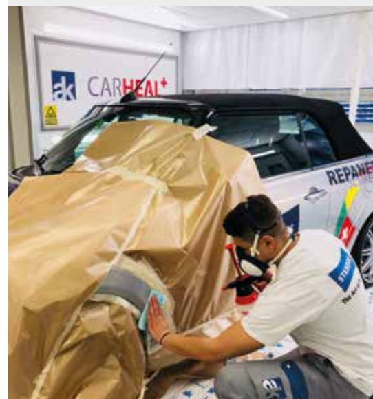
Gianluca Lucifora, Anwendungstechniker der André Koch AG, bei der MicroRepair-Reparatur in der mobilen Lackierbox von Carheal.
